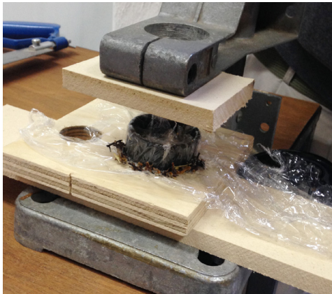
Proceso de experimentación y prensado del escobajo para transformarlo en un nuevo material.
